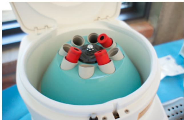
Mynd 1. Hér hefur þremur glösum verið komið fyrir í skilvindunni. Þetta er aðskilið í átta mínútur á 1300 snúningum.
