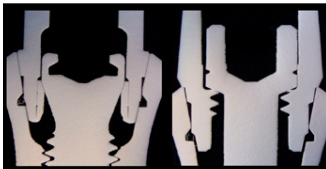
Mynd 13. Til vinstri er upprunalegt abutment sem sest óaðfinnanlega niður í tannplantann og fær þannig góða viðloðun. Abutmentið til hægri er eftirlíking sem situr á brún plantans og fær því enga viðloðun við vegg plantans. Þetta abutment fær stöðuleika einungis frá abutment skrufunni og hættu á skrufulosi er talsverð.
